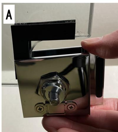
欠き取り沿って①パッキンを硝子の両面に貼ります。②本体を硝子に押し込みます。
