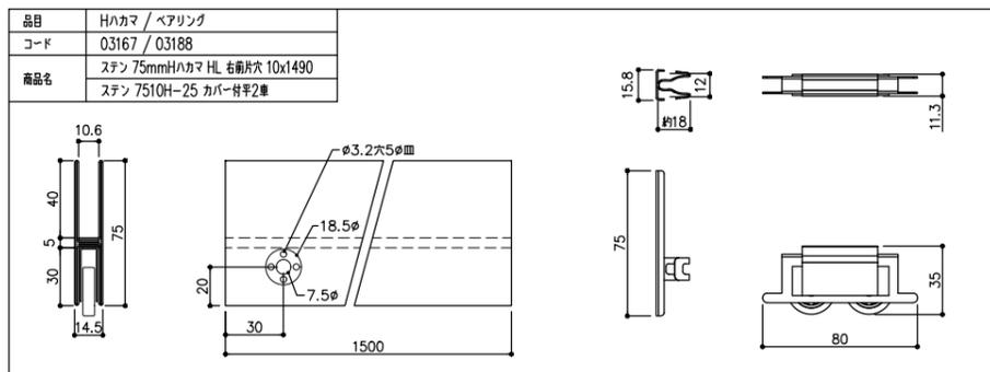
75Hハカマ 12mm ※推奨ガラスサイズ H 3000mm以下 最大耐荷重 戸車4個 /90kg /1枚
